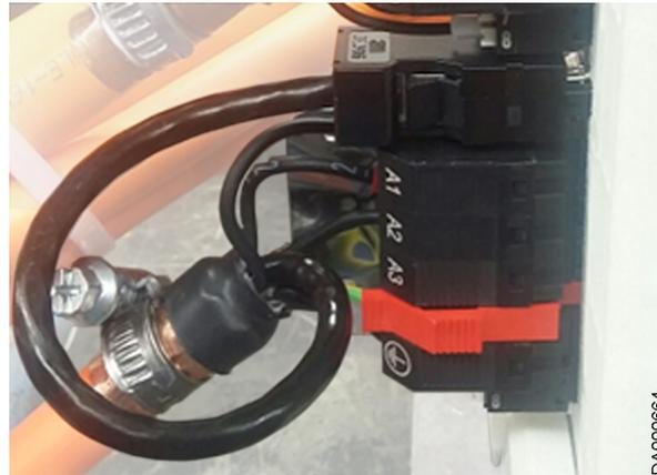
Fig. 52 : Guidage de câble codeur en forme de boucle vers le point de raccordement XG20
