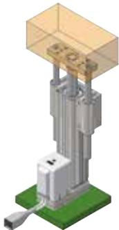
Élévateur de charge verticale – mouvement de quatre actionneurs électriques
