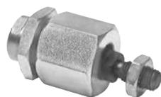
Chape compensatrice pour le montage articulé de la tige de piston. La chape permet de corriger l'erreur d'angle axial dans une plage de  $\pm 4^\circ$ .
