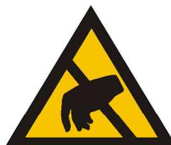
Des parties sensibles peuvent recevoir des décharges électrostatiques : observer les précautions de contrôle électrostatique.
