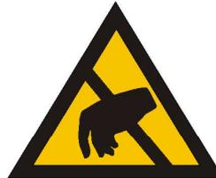
Des parties sensibles peuvent recevoir des décharges électrostatiques : observer les précautions de contrôle électrostatique.
