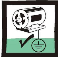
Le moteur doit être relié à une mise à la terre appropriée
