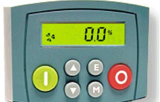
Pour modifier le mode de fonctionnement : sur le 890 CS vous pouvez changer le mode de fonctionnement Local ou Remote à tout instant sur le MMI. Par contre sur le module 890CD vous devez être dans le menu supérieur du MMI, en visualisation de la version software, avant de changer en mode local ou remote.
