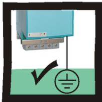
L'appareil doit être **mis à la terre en permanence** en raison du fort courant de fuite à la terre.
