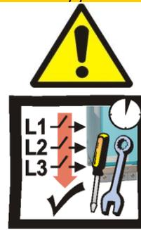
Avant de travailler sur l'appareil, coupez l'alimentation secteur au niveau des bornes L1, L2 et L3 et attendez 3 minutes.
