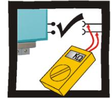
Débranchez l'appareil des circuits lorsque vous procédez à des contrôles d'isolation à tension élevée.
