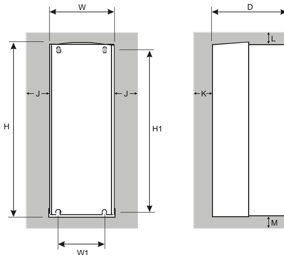
Les appareils doivent être installés dans une armoire. Montez le variateur à l'aide des trous et des rainures prévus à cet effet.
