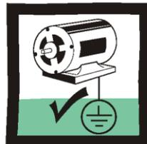
Le moteur du variateur doit être raccordé à une prise de terre adaptée.
