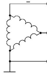
Lors de la connexion d'un servorégulateur à un réseau IT, il faut monter un transformateur de séparation. Compax3 est alors opéré local comme dans un réseau TN. Le milieu côté secondaire du transformateur de séparation doit être mis à la terre et être relié au connecteur PE du Compax3.
